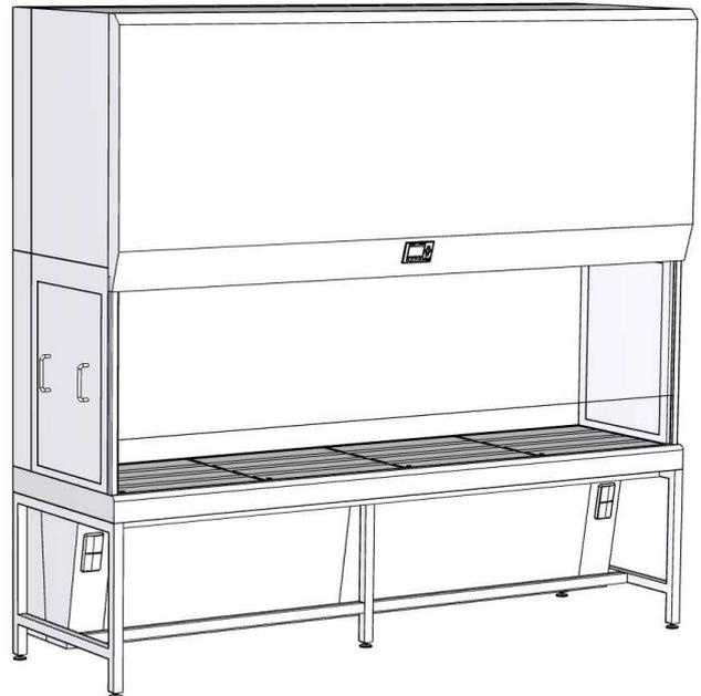
Im Bereich innerhalb der Sicherheitswerkbank herrscht eine turbulenzarme Luftströmung, die die Anforderungen der Reinheitsklasse 5 nach ISO 14644-1 erfüllt.
